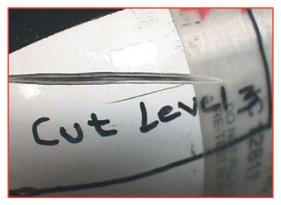
Beschädigungsgrad 2 in <u>Tabelle 3</u> überschreiten. Bei Schnitten dieser Tiefe wird normalerweise die Kohlefaser unter der Glasfaserschicht freigelegt.
