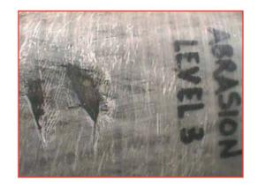
Flaschen die Abrieb der Kohlefasern aufweisen, sind unbrauchbar.
