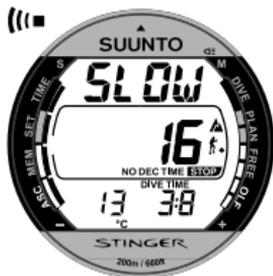
Abb. 3.15. Aufstiegsgeschwindigkeitsanzeige. Blinkendes SLOW und 4 Segmente werden angezeigt, ein akustischer Alarm ertönt: Aufstiegsgeschwindigkeit liegt über 10m /Min. [33ft/ min]. Dies ist ein Hinweis, die Geschwindigkeit zu reduzieren. Das STOP- erscheint, weil Sie einen vorgegebenen Sicherheitsstopp in einer Tiefe von 6m [20ft] durchführen sollten.
