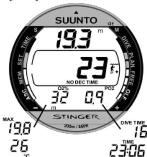
Abb. 3.22. Tauchen im Nitrox-Modus.  $O_2\%$  ist auf 32% eingestellt.
