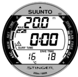
Abb. 3.24. Anzeige im Oberflächenmodus. Sie haben einen 18-minütigen Tauchgang durchgeführt, dessen maximale Tiefe 20,0m [66ft] betrug. Ihre aktuelle Tiefe ist 0,0m [0ft] und die Dauer der Oberflächenpause beträgt 0 Min. Das Flugverbots-Symbol zeigt, dass Sie nicht fliegen sollten und das ACHTUNG-Symbol weist Sie darauf hin, dass Sie Ihre Oberflächenpause wegen des Auftretens von Mikrobläschen verlängern sollten.
