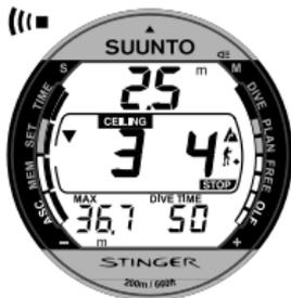
Abb. 3.14. Verletzung des verbindlichen Sicherheitsstops. Der abwärts gerichtete Pfeil und der akustische Alarm weisen Sie darauf hin, auf die geforderte Tiefe abzutauchen.
