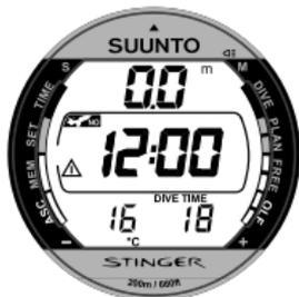
Abb. 3.25. Anzeige an der Oberfläche. Die alternierende Anzeige zeigt die Flugverbotszeit
