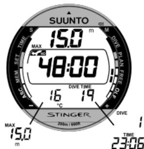
Abb. 3.35. Alternierende Anzeige nach einem Tauchgang im Tiefenmessermodus. Das mittlere Displayfenster zeigt die Flugverbr.
