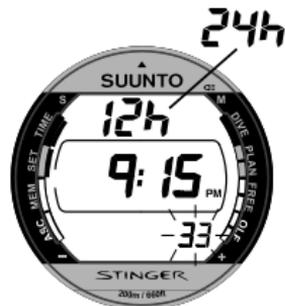
Abb. 4.3. Der Modus zur Zeiteinstellung ist aktiv und die zweiten Ziffern blinken. Seite I.
