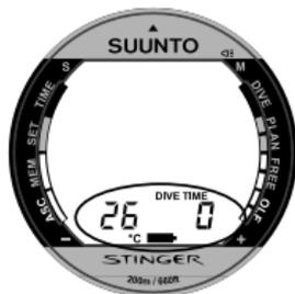
Abb. 3.6. Batteriewarning. Das Batteriesymbol zeigt eine geringe Batteriespannung an. Die Batterie sollte ersetzt werden.
